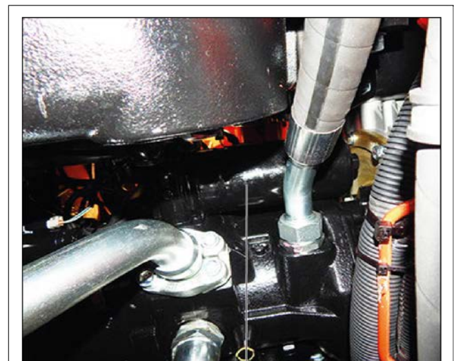
Figure 173: Vérification de la contamination de l'huile hydraulique
